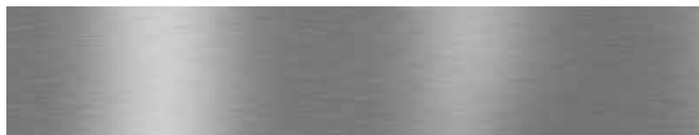
Acier inoxydable AISI 304 avec finition satinée.
